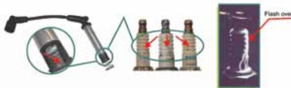
**Nota:** La substitución de las bujías de encendido con desgaste excesivo en los electrodos puede evitar daños en otros componentes del sistema de encendido(cables, tapa del distribuidor, bobinas y/o transformadores). La durabilidad dependera del tipo de bujía, del combustible utilizado, de las condiciones de uso y del sistema de encendido del vehículo.
